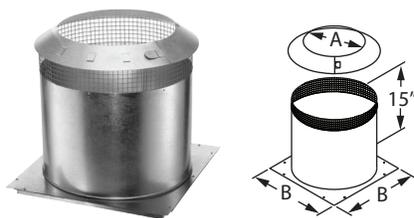
Utiliser lorsque la cheminée traverse dans le grenier pour empêcher isolant et débris de faire contact avec la cheminée, sauf si la cheminée est entourée d'un enclos. S'installe sur le coupe-feu radiant ou sur le support de plafond. Se compose de deux parties - un collet et une base. Manchon avec maille autour de la partie supérieure.
